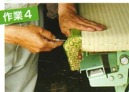
畳縁を機械で縫い留め、端の始末をして完成です。
