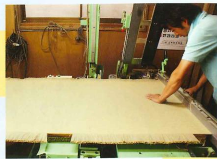
古い畳表を外し、新しい畳表をのせ、端を縫い、サイズ調整していきます。
