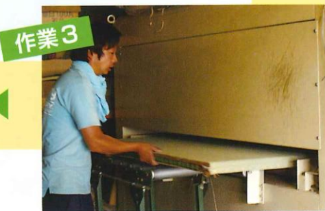
イ草表の加工時に残った僅かな汚れを洗浄します。
