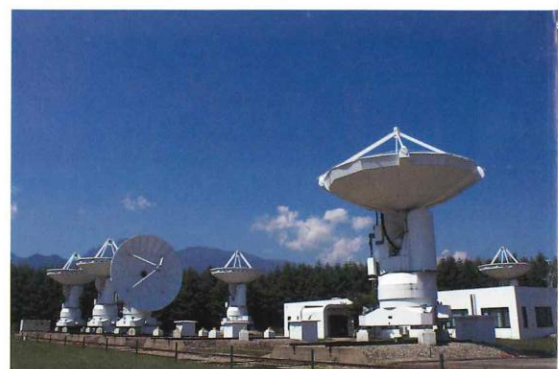
▲ミリ波干渉計。天体の細かい構造を調べます。
